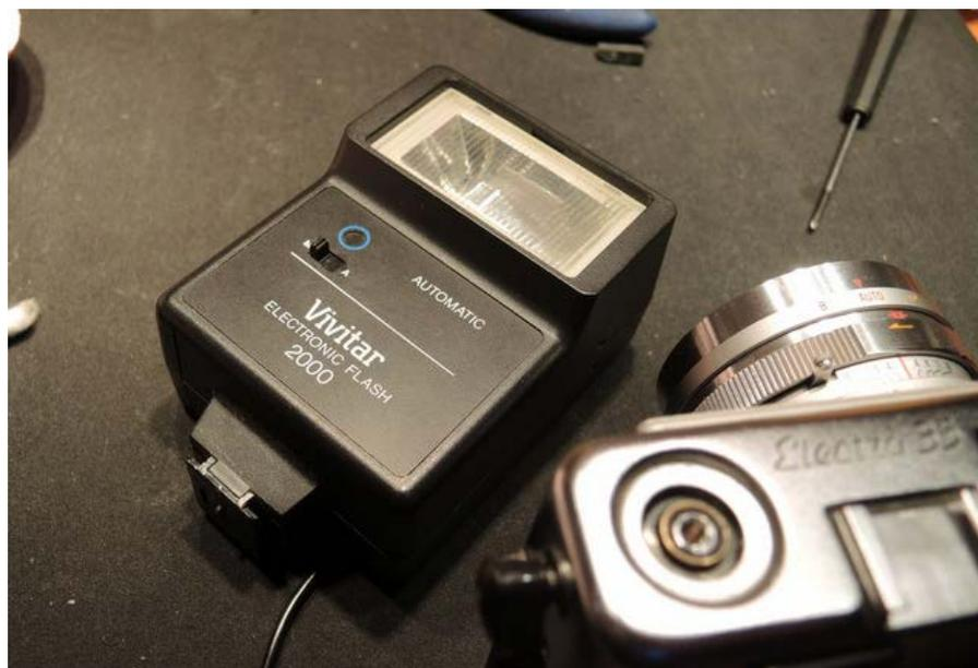
Ressoudez le fil de synchro-flash, remettre la capot supérieur en place et testez la synchro avant d'aller plus loin.
