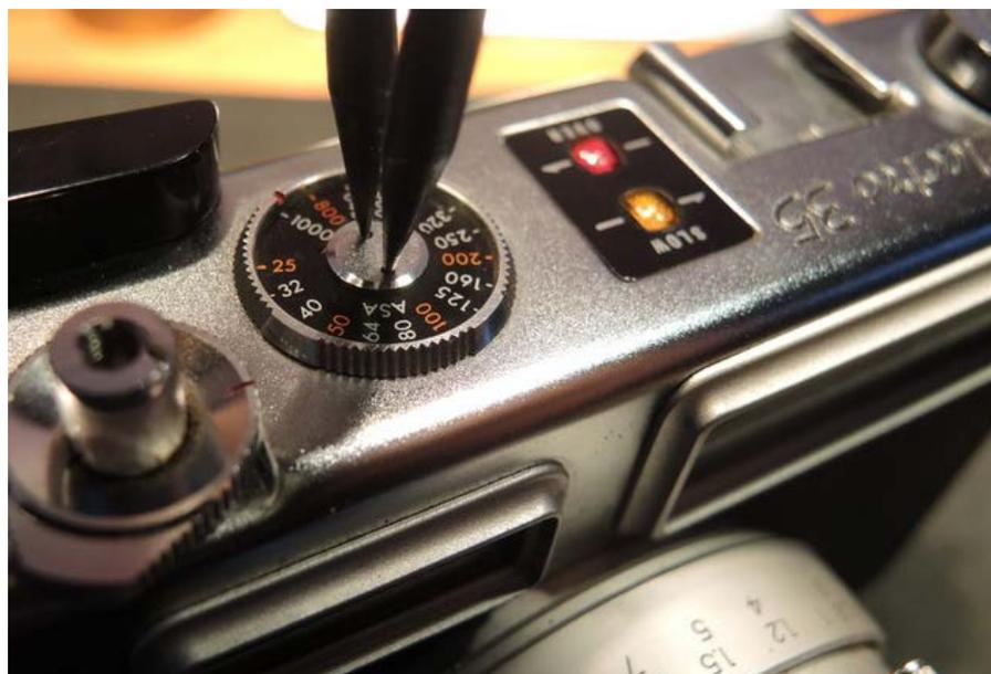
... et pour la molette de sélection de la sensibilité. les deux pas de vis se démontent classiquement, en sens inverse des aiguilles d'une montre.
