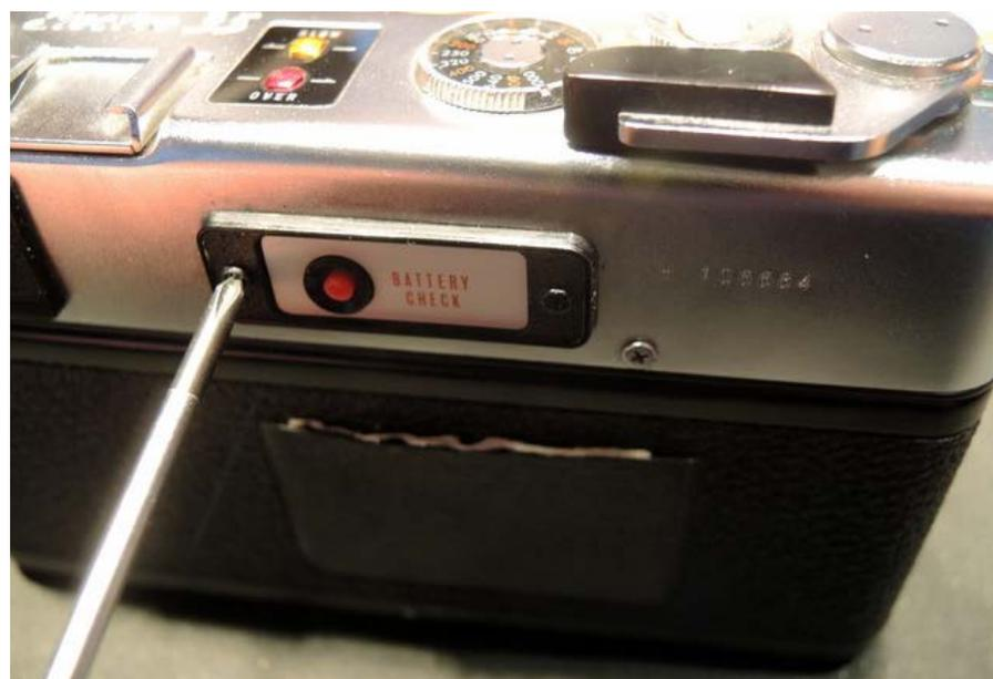
La trappe avec le bouton de test de pile est fixée par 2 vis (attention à ne pas laisser tomber le bouton rouge dans l'appareil...)
