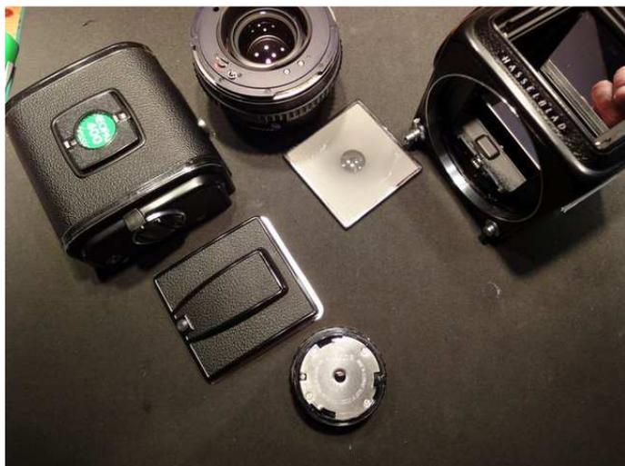
A l'aide d'un "spanner", démonter la vis de fixation de la platine sur laquelle vient se fixer la molette d'avancement/armement (sens inverse des aiguilles d'une montre)
