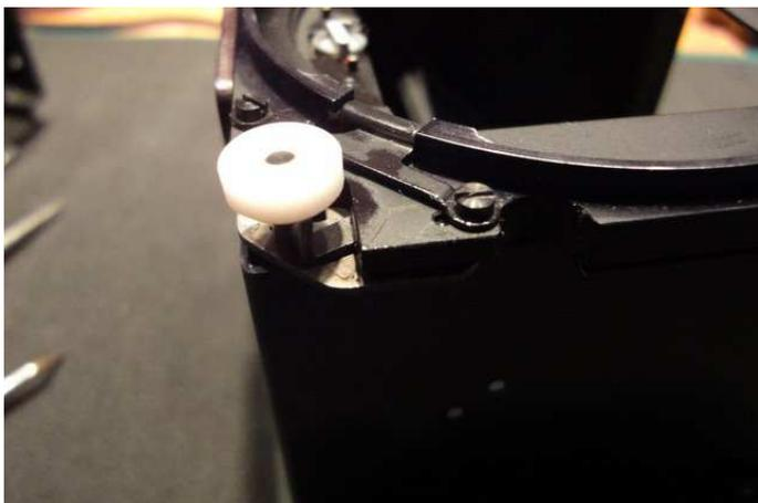
Il est également nécessaire dans les derniers millimètres d'aider le **bouton de verrouillage du miroir** à se mettre en place en actionnant vers l'avant le **levier**, et de veiller au centrage de la baïonnette porte-objectifs dans son logement.
