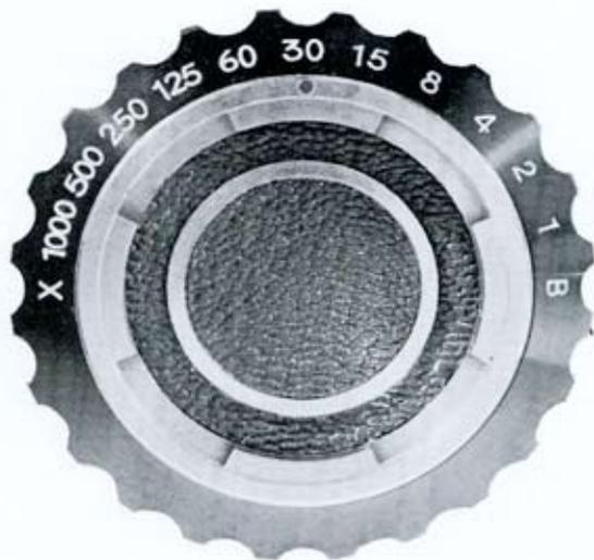
L'obturateur focal vertical, possède un rideau gainé de caoutchouc et les repères de vitesses sont indiqués par un seul bouton non rotatif.
