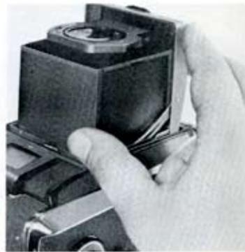
Pour enrouler le film il faut tourner la manivelle jusqu'à l'arrêt complet de celle-ci, même si vous entendez un léger déclic avant d'arriver à la butée; Ce petit bruit indique que l'obturateur est armé mais que le film n'est pas encore avancé. Si l'on presse sur l'obturateur, on obtient une double exposition.
