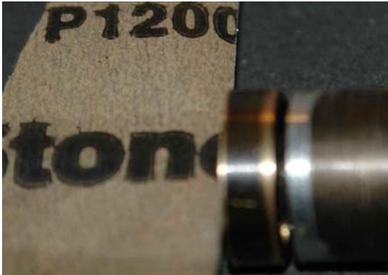
Avant de démonter l'ensemble rideaux / cylindres, détendre les ressorts des rideaux (sens inverse des aiguilles) en comptant les tours jusqu'à relâchement complet en position « déclenché » (chez moi, 45 et 160 tours de vis sans fin) de manière à avoir un réglage « de base » après remontage
