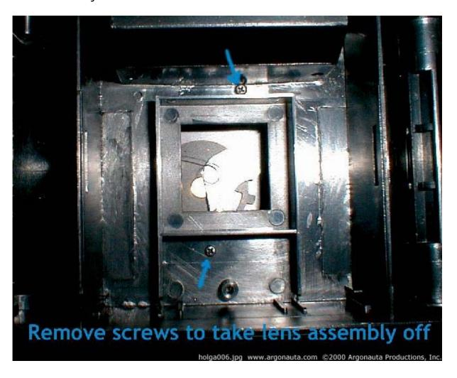
3. Retirez l'ensemble objectif + obturateur. Pour les appareils disposant d'un sabot de flash, coupez les fils désormais inutiles.
